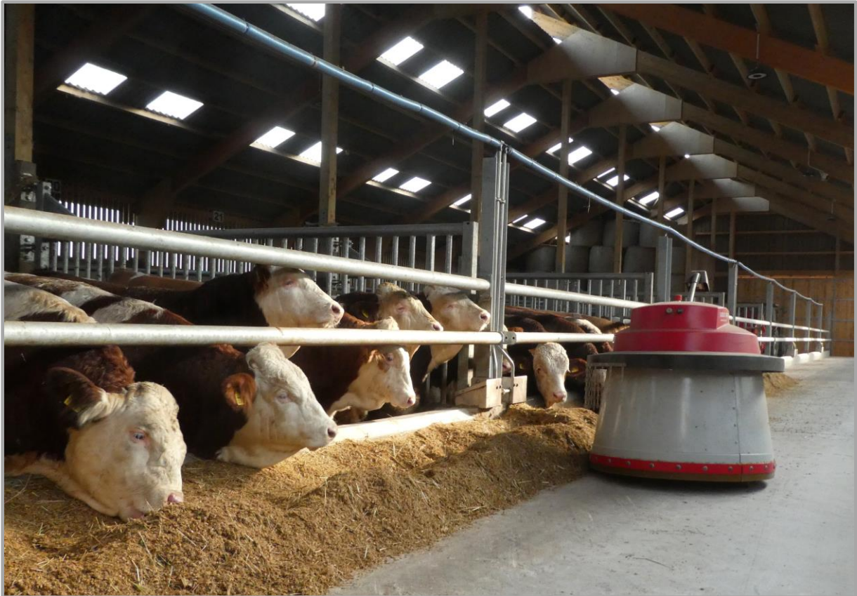
Abb. 15: Futteranschiebe-Roboter schieben die Ration nach einmalig festgelegten Routen mit jeder weiteren Fahrt näher zu den Tieren (Foto: Tierschutzdienst).
